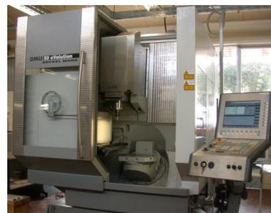
*Macchina utensile a controllo numerico a 5 assi Deckel Maho*
